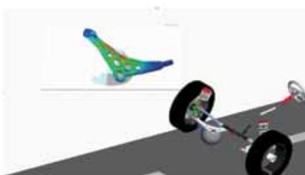
Simpack 提供了与 Abaqus 软件的直接数据接口，能进行两者之间的联合仿真，实现在运动过程中非线性柔性体部件与多体动力学系统之间的相互耦合，更加精确模拟现实情况。
