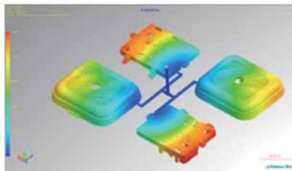
SIMPOE 是注塑成型仿真软件，包括求解器 Simpoe-Mold 以及用户界面 SimpoeMV。SIMPOE 可以帮助模具设计人员和注塑成型工程师预知成型过程中的力学状态，例如流动模式、压力、熔化温度、剪切力、剪切速率、收缩、翘曲、纤维方向、薄壁结构厚度等分布情况；还可以评估模具温度、成型循环时间等参数。通过这些参数设计人员可以评估合适的成型条件和模具设计参数，比如浇注口的位置、通风口的位置、流道设计等。此外，通过 SIMPOE 软件还可以评估注射压力、模具温度、锁模力、保压时间和压力等参数。SIMPOE 软件是评估整个注塑成型过程的强有力的工具。
