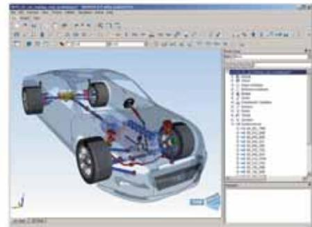
Simpack 能进行运动学、动力学、逆动力学、频域、模态等多种分析，核心的递归算法保证了求解的稳定性和可靠性，即使像车轮脱离轨道再接触这类的强非线性接触问题，Simpack 软件亦能轻松处理。
